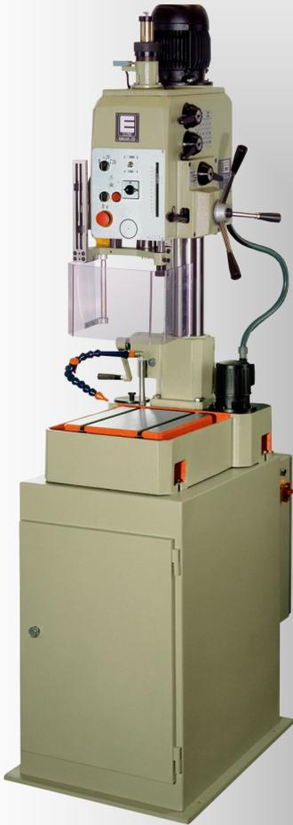
Perceuses à colonne ,ou d'établi à descente manuelle ou automatique, entraînement par courroies ou pignons rectifiés, embrayage mécanique ,ou électromagnétique, table fixe ou réversible, réglable en hauteur.
