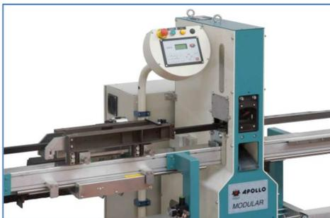
Une autre poinçonneuse qui est très vendue est la **MODULAR SIMPLIFIÉE**, elle aussi peut être fournie dans des versions différentes, elle peut avoir une tête vertical ou horizontale, ou deux têtes horizontales ou, dans la version "**COMPACTE**", une tête de 10 tons.
