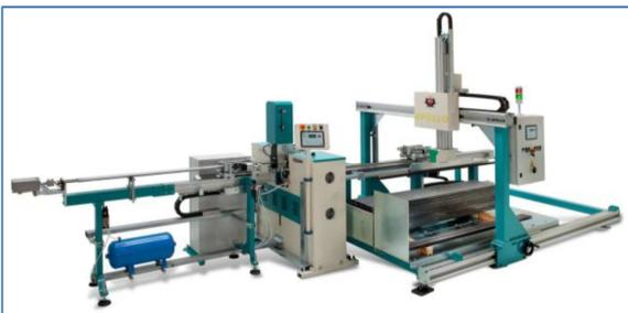
Comme alternative il y a un manipulateur à C.N. avec des axes cartésiens qui charge les tubes qui doivent être poinçonnés et décharge les tubes poinçonnés dans deux
