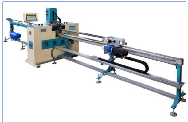
Les outils en dotation sont innovateurs au niveau technologique pour ce qui concerne les matériaux et leurs applications. Ils donnent à la machine une grande vitesse de glissement des tubes sans rayures. La machine peut usiner des tubes semiovaux ou rectangulaires sans timbrage grâce à notre système exclusif.
