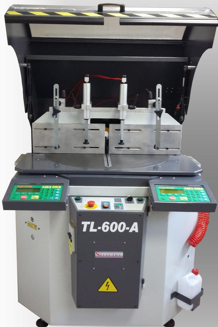
Scie fraise semi- automatique pour Aluminium et PVC.
