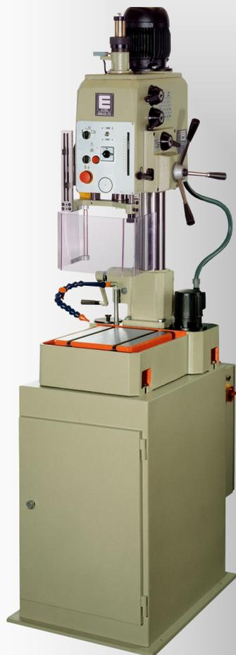
Perceuses à colonne ,ou d'établi à descente manuelle ou automatique, entraînement par courroies ou pignons rectifiés, embrayage mécanique ,ou électromagnétique, table fixe ou réversible, réglable en hauteur.
