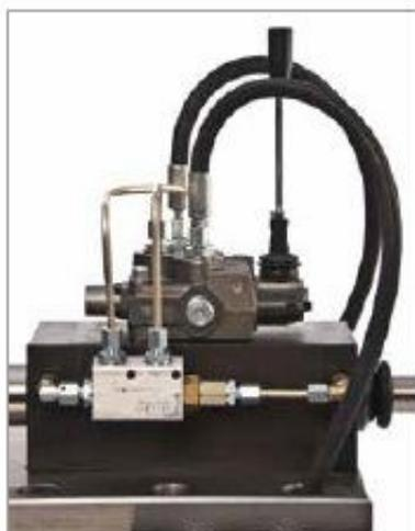
Commande hydraulique manuelle
