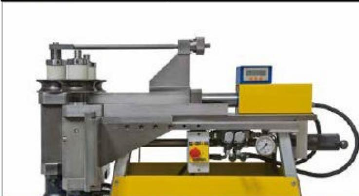
Affichage digitale, manomètre, butées mécanique, commandes manuelles
