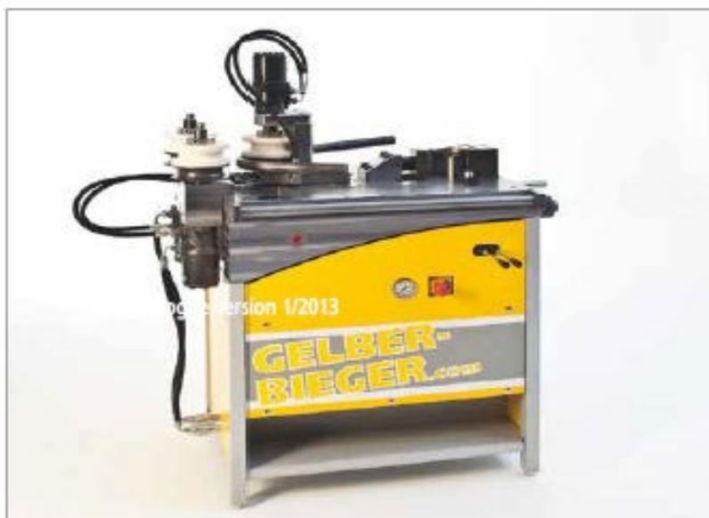
Presse XS avec kit cintrage 3 galets et outil de pliage H= 100 mm
