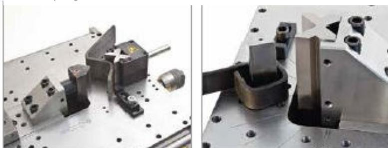
Outil de pliage hauteur 100 mm    Outil pliage pièces fermées
