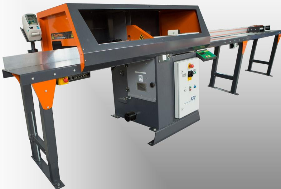
La TS350 est une machine de coupe automatique à lame ascendante.
